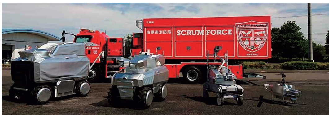
実戦配備型消防ロボットシステム
